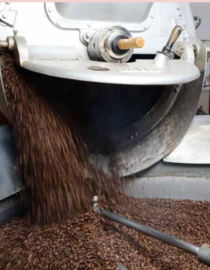
Machine à torréfier le café - capacité 80 kg par cycle. Un cycle dure environ entre 15 à 20 minutes.
